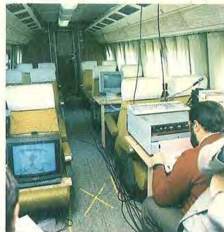
En el interior del Electrotrén, se montaron aparatos de registro, ordenadores y un monitor de vídeo para observar el comportamiento del pantógrafo.
