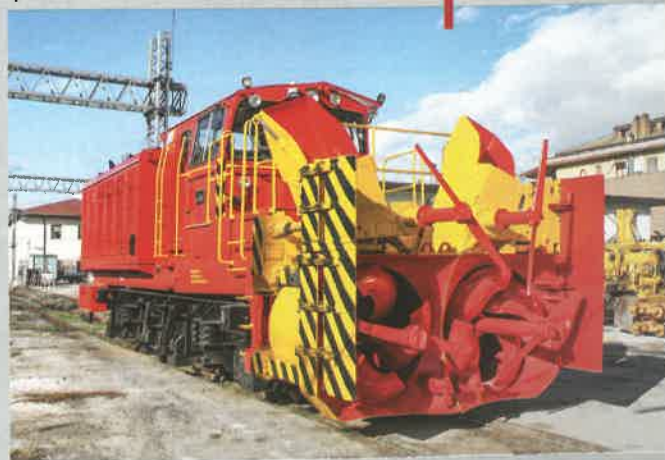
Lo sgombraneve S.244.001 (acquisito da FS nel 1981), Tipo HB1000 S-18 costruito da Beilhack (D) con residenza Sulmona e in uso a RFI è stato oggetto, presso Elen Machines Srl, di una completa revisione finalizzata a mantenerne la funzionalità per l'utilizzo in caso nevicate di particolare intensità sulle linee abruzzesi e molisane. Nelle immagini lo stato in cui si presentava prima della revisione (18 maggio 2014, foto M. Sebastiani) e in quello attuale (9 dicembre 2024, foto A. Vacca).
