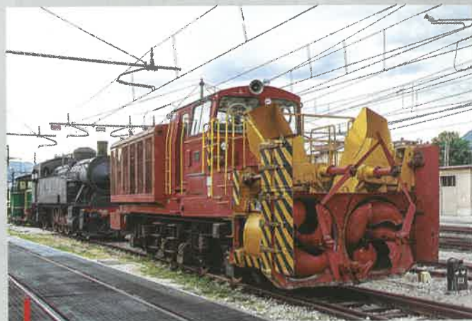
Lo sgombraneve S.244.001 (acquisito da FS nel 1981), Tipo HB1000 S-18 costruito da Beilhack (D) con residenza Sulmona e in uso a RFI è stato oggetto, presso Elen Machines Srl, di una completa revisione finalizzata a mantenerne la funzionalità per l'utilizzo in caso nevicate di particolare intensità sulle linee abruzzesi e molisane. Nelle immagini lo stato in cui si presentava prima della revisione (18 maggio 2014, foto M. Sebastiani) e in quello attuale (9 dicembre 2024, foto A. Vacca).
