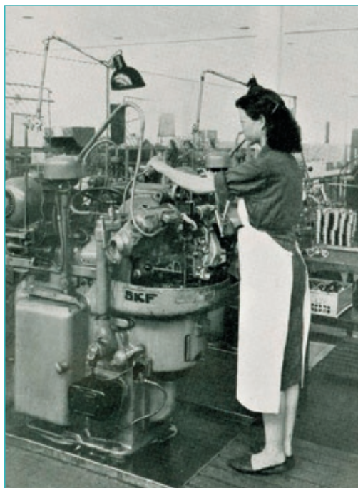
Empresa Nacional de Rodamientos, S.A. Rectificación del camino de rodadura. Resumen de Finalidades y Actuación del Instituto Nacional de Industria y de las Empresas en que participa hasta el 31 de diciembre de 1952. Información gráfica.
