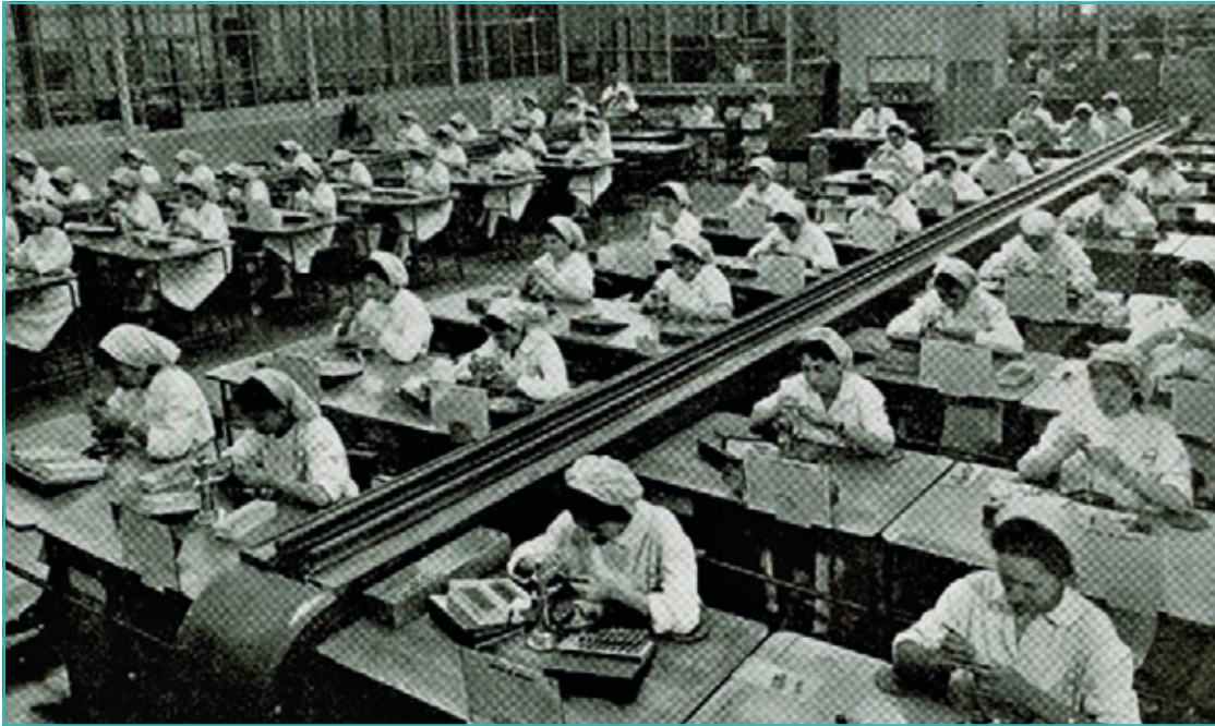
Trabajadoras en Marconi, Villaverde. Montaje de válvulas. Resumen de Finalidades y Actuación hasta el 31 de diciembre de 1962.
