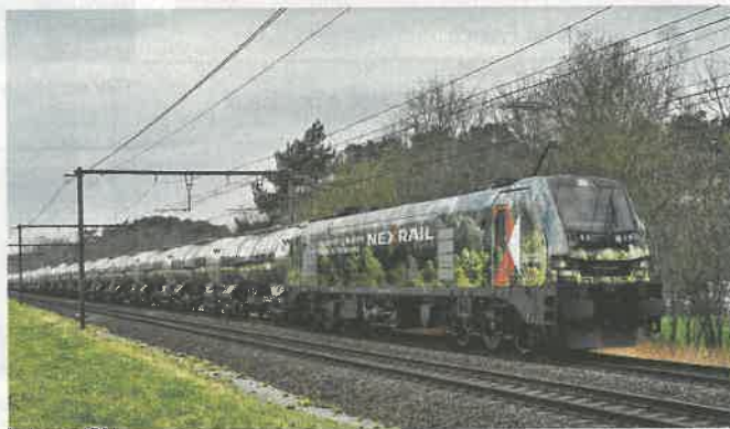
Les EURO9000 électriques seront équipées de batteries pour circuler sur des lignes sans caténaire.
